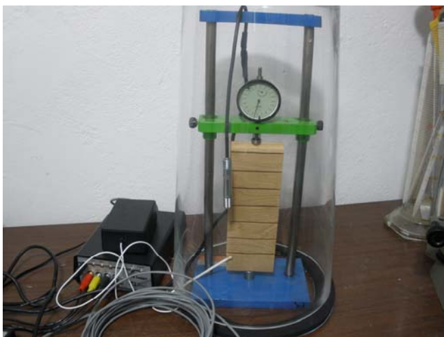
F1. Dettagli della camera climatica con sistema di variazione di temperatura ed umidità.
