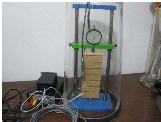
F1. Dettagli della camera climatica con sistema di variazione di temperatura ed umidità.
