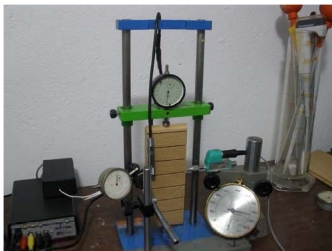
F2. Dettagli del complesso dei sistemi di misurazione in ambiente climatizzato fino al 85% di URA.
